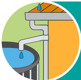
4. Cosecha de agua de lluvia con techos y almacenamiento en tanques tipo Zamorano
